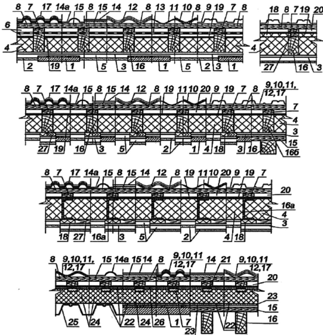
1 - сборная или монолитная железобетонная плита; 2 - внутренняя обшивка; 3 - пароизоляция; 4 - плитный утеплитель;
