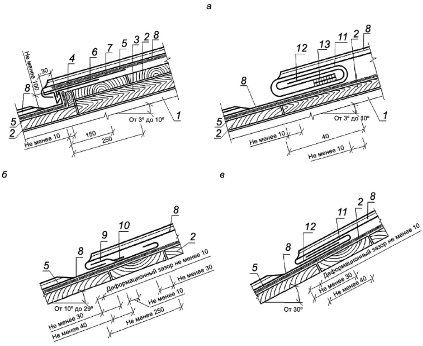
1 - стропило; 2 - сплошной деревянный настил; 3 - доборный брус; 4 - доска; 5 - подкладочный ковер из рулонных материалов или объемная диффузионная мембрана; 6 - костыль; 7 - металлическая полоса; 8 - металлический лист; 9 - фальшпланка; 10 - припой; 11 - загнутый край нижней картины; 12 - загнутый край верхней картины; 13 - уплотнительная лента
