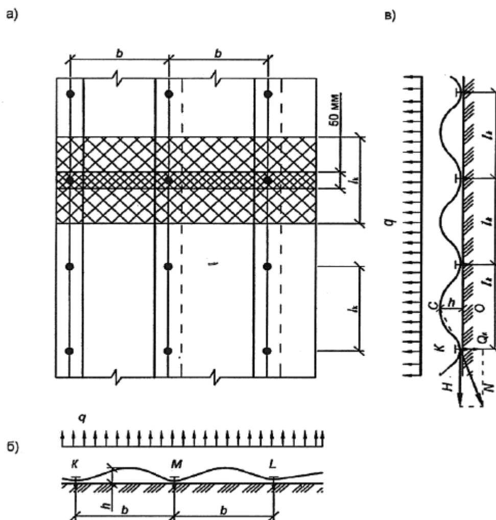
$b$  - ширина полотнищ рулонного материала;  $H$  - распор;  $h$  - высота подъема кровельного ковра;  $l_k$  - расстояние между крепежными элементами;  $N$  - продольное усилие;  $q$  - распределенная ветровая нагрузка, Н/м;  $C, K, L, M, O$  - точки
