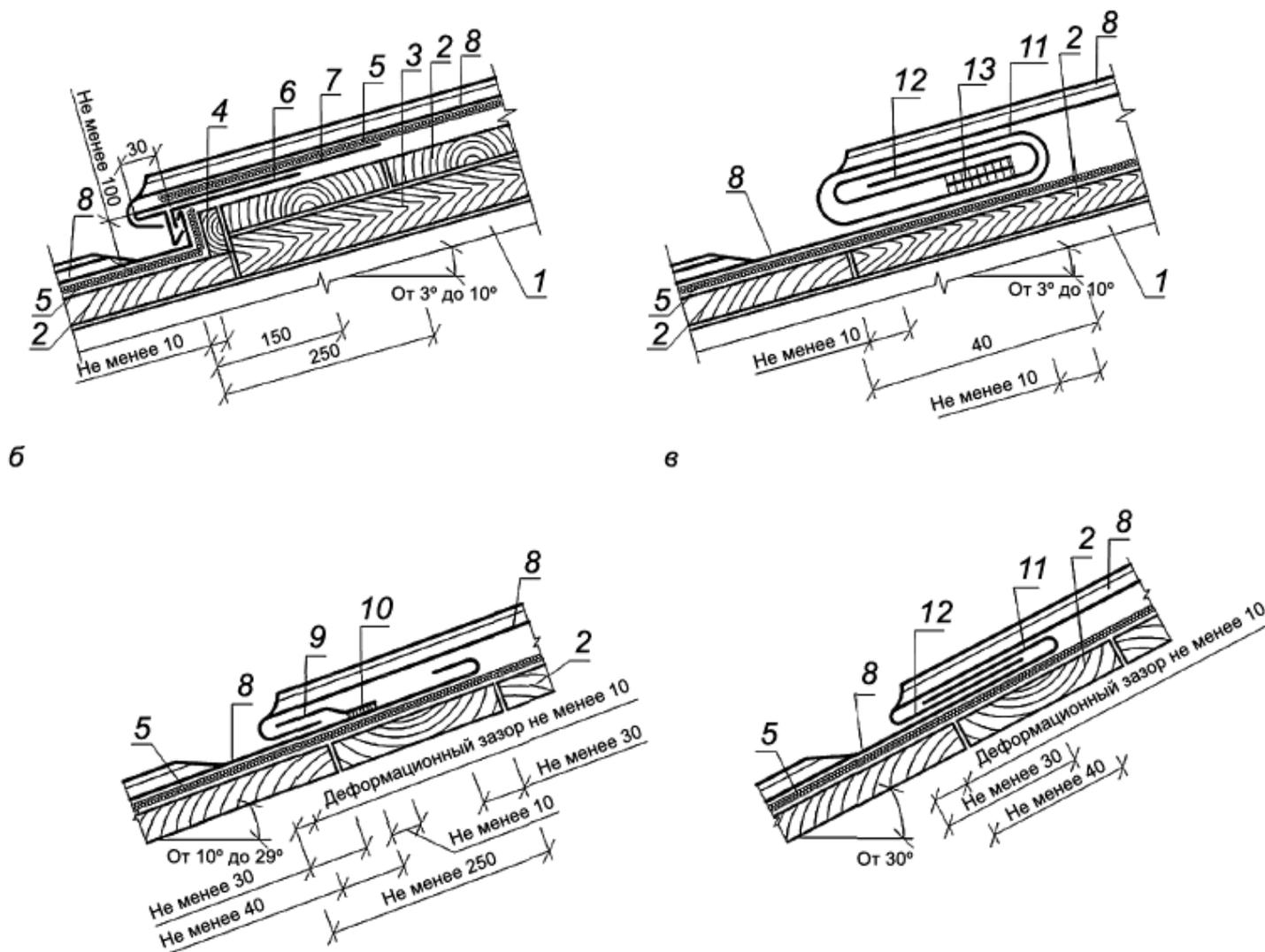
1 - стропило; 2 - сплошной деревянный настил; 3 - доборный брус; 4 - доска; 5 - подкладочный ковер из рулонных материалов или объемная диффузионная мембрана; 6 - костыль; 7 - металлическая полоса; 8 - металлический лист; 9 - фальшпланка; 10 - припой; 11 - загнутый край нижней картины; 12 - загнутый край верхней картины; 13 - уплотнительная лента
