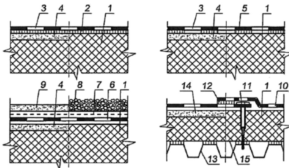
1 - теплоизоляция; 2 - сплошная приклейка; 3 - ковер; 4 - выравнивающая стяжка; 5 - частичная приклейка ковра; 6 - свободно уложенный ковер; 7 - предохранительный слой; 8 и 9 - пригруз из гравия или бетонных плиток (моноконтный цементно-песчаный раствор, асфальтобетон); 10 - механически закрепленный ковер; 11 - крепежный элемент с шайбой; 12 - приклейка (сварка) продольных кромок рулонных материалов; 13 - профилированный настил; 14 - сборная стяжка; 15 - пароизоляция
