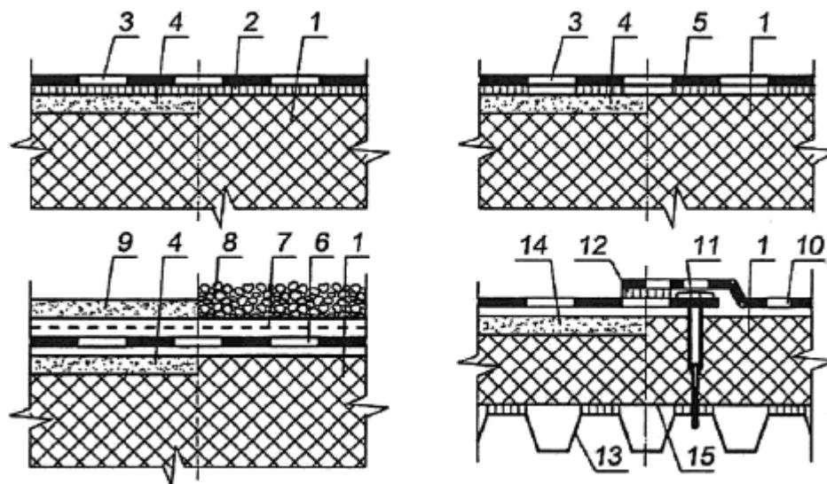
1 - теплоизоляция; 2 - сплошная приклейка; 3 - ковер; 4 - выравнивающая стяжка; 5 - частичная приклейка ковра; 6 - свободно расположенный ковер; 7 - предохранительный слой; 8 и 9 - пригруз из гравия или бетонных плиток (монолитный цементно-песчаный раствор, асфальтобетон); 10 - механически закрепленный ковер; 11 - крепежный элемент с шайбой; 12 - приклейка (сварка) продольных кромок рулонных материалов; 13 - профилированный настил; 14 - сборная стяжка; 15 - пароизоляция
