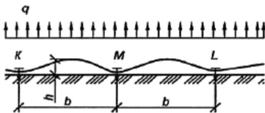
$b$  - ширина полотнищ рулонного материала;  $H$  - распор;  $h$  - высота подъема кровельного ковра;  $l_k$  - расстояние между крепежными элементами;  $M$  - продольное усилие;  $q$  - распределенная ветровая нагрузка, Н/м;  $C$ ,  $K$ ,  $L$ ,  $M$ ,  $\bigcirc$  - точки
