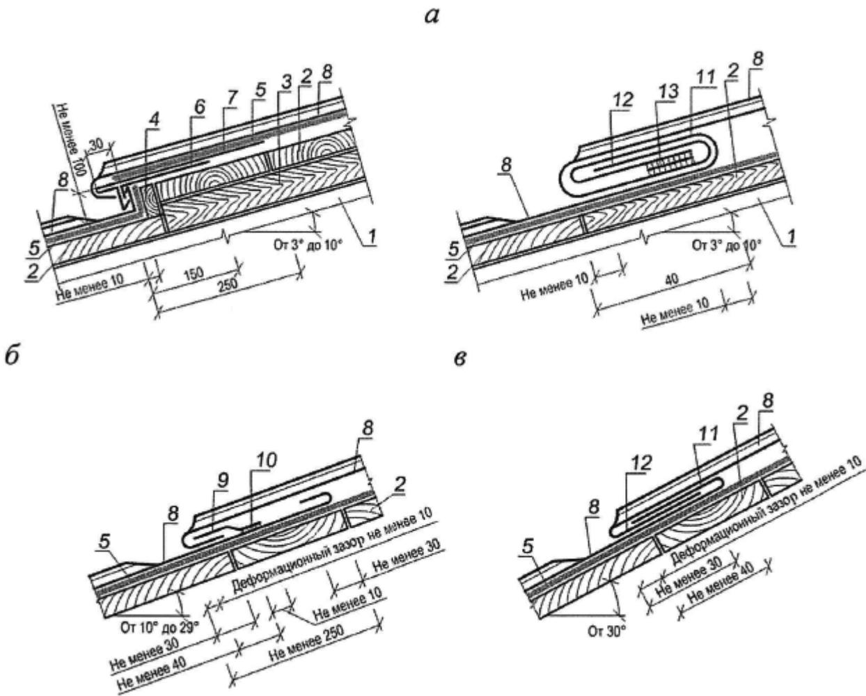
1 - стропило; 2 - сплошной деревянный настил; 3 - доборный брус; 4 - доска; 5 - подкладочный ковер из рулонных материалов или объемная диффузионная мембрана; 6 - костьль; 7 - металлическая полоса; 8 - металлический лист; 9 - фальшпланка; 10 - припой; 11 - загнутый край нижней картины; 12 - загнутый край верхней картины; 13 - уплотнительная лента
