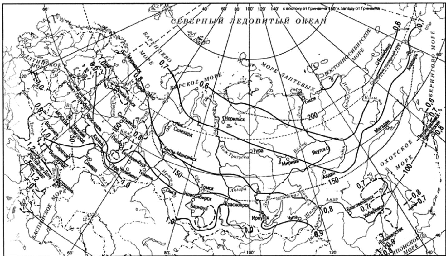
Рисунок 1 - Климатические коэффициенты для определения величины нагрузки на иловые площадки (сплошные и пунктируемые линии) и продолжительности периода намораживания на иловых площадках, дни (точечные линии)
