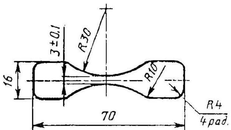
Рисунок 2 - Образец-лопатка типа 2
