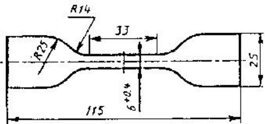
Рисунок 1 - Образец-лопатка типа 1
